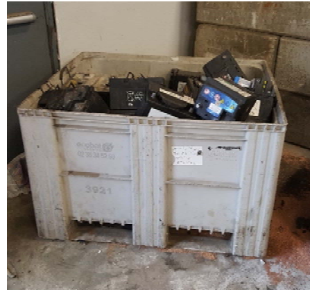
Photo 12. Bacs de 1m 3 étanches conçus pour l'entreposage des accumulateurs au plomb (Source : REMED )
