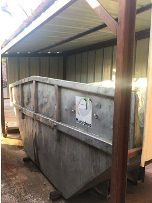
Photo 2. Benne inox étanche et couverte de regroupement des accumulateurs au plomb (Source : REMED)
