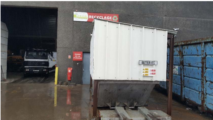
Photo 11. Benne inox étanche et couverte de regroupement des accumulateurs au plomb (Source : auddicé env. )
